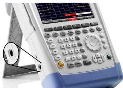
El R&S FSH se suministra con corriente de un transformador de alimentación CA/CC conectado a el conector CC. También puede utilizar el conector CC para cargar la batería.
