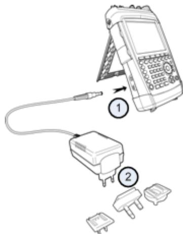
El rango de voltaje de una fuente de alimentación CA es 100 V a 240 V.
