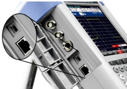
Puede conectar el R&S FSH a un PC vía USB o LAN y transferir datos en ambas direcciones.
