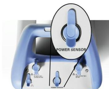
La conexión está específicamente configurada para sensores de potencia. Se usa tanto para alimentar el sensor como para transferir datos a través del interfaz del sensor de potencia.
